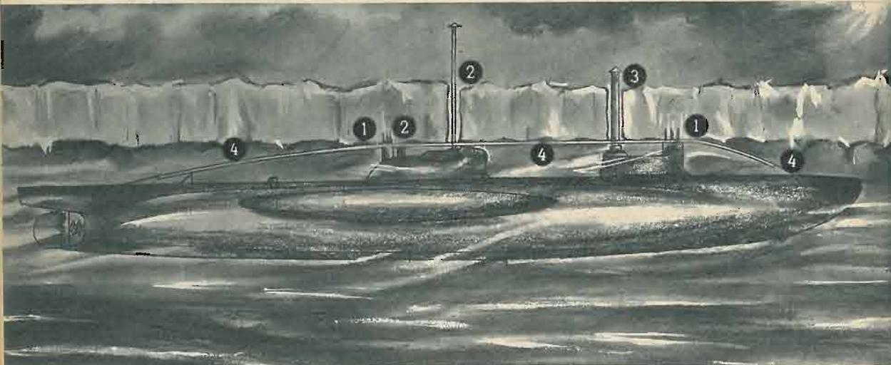
◀ **Sommergibile per esplorazione polare subacquea progettato dal com.te Mariano. L'unità poteva fissarsi alla banchisa mediante due arpioni (1) e doveva essere dotata di trivelle telescopiche per forare il ghiaccio. Le due frese piccole (2) dovevano servire ad eseguire fori per l'aerazione; quella maggiore (3) era destinata a creare un passaggio per il personale. Sopra lo scafo una specie di slitta (4) doveva evitare che il sommergibile urtasse contro la banchisa.**
